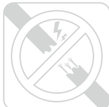
Kontrollér for beskadigede kabler
